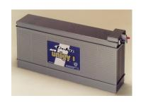
"单元式" VRLA 蓄电池几乎都是由单独的 2 V 电池组成,一般水平安装,以便其所有连 线和维护都从系统"前面"进行。这些电池常常打包为钢制"模块",而这些模块能够叠 放,串联和/或并联。该类型电池最常用于希望实现长时间、高功率备用的电信应用。
