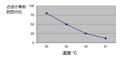
循环寿命 - 较少使用的电池,其寿命明显长于每天都充放电的电池。生产商的产品简介中很少公布电池的循环寿命。每次,您通过电池供电,就是在放电。您放电的功率瓦数和时间长度决定了"放电深度"(DOD)。电池放电速率、两次放电之间充电的时间,以及充电速率也都很重要。在电池的设计中,通常假设每年有 2-3 次深放电(放电深度为 100%)。一般来说,一个 VRLA 蓄电池能提供上百次的浅放电(放电深度<25%)。而在现场实际运行过程中,将有多种类型的充放电情况。
